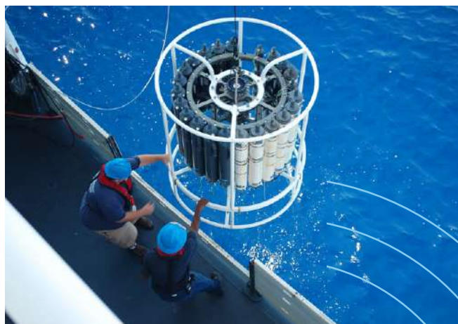
Les prélèvements sont réalisés à partir d'une CDT-rosette © Officiers et équipage du navire PISCES de la NOAA
