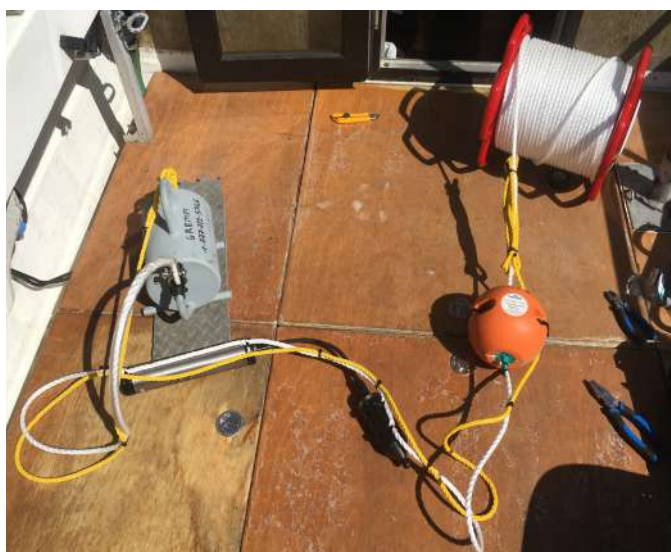
De gauche à droite: l'ancre métallique, la pile supplémentaire, l'hydrophone (partie noire), la bouée et le rouleau de corde qui sert à remonter l'ensemble à la surface.
