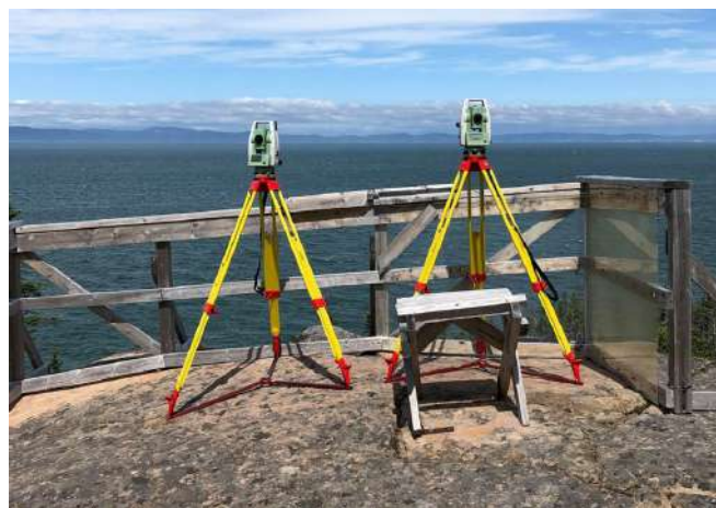
Les mesures sont enregistrées avec un tachéomètre, aussi appelé « station totale », installé à 30 m de hauteur. © Camille Kowalski
